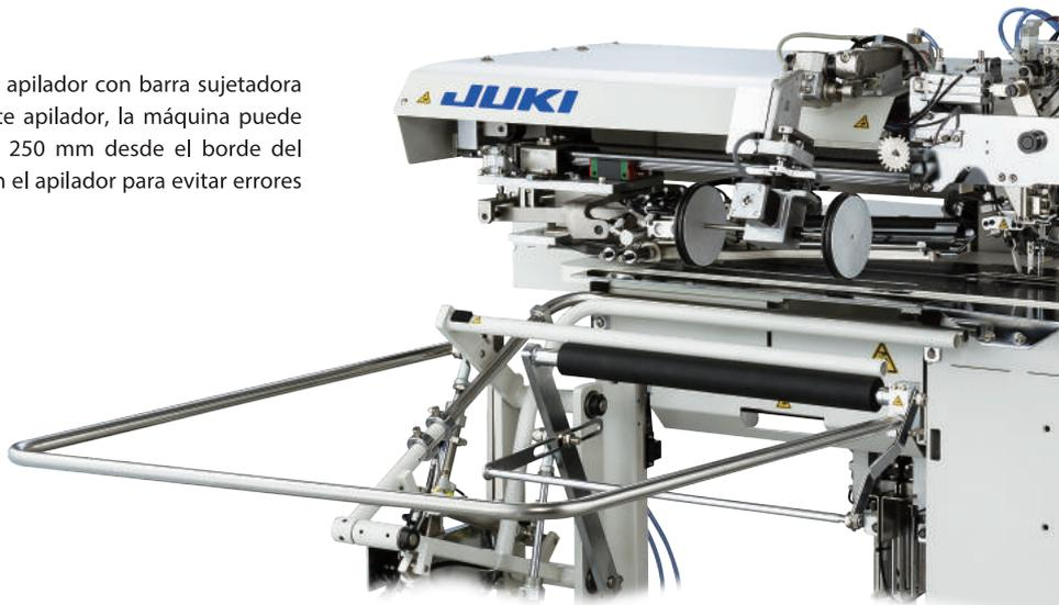
SP-46N: Apilador con barra sujetadora
